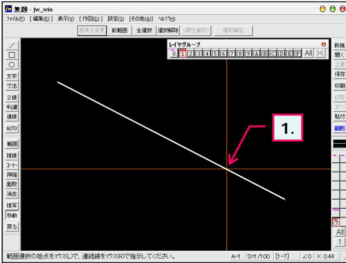
1. 鉛直線を描きたい直線上でマウス右ボタンを押したまま上(0時方向)へ移動します。
