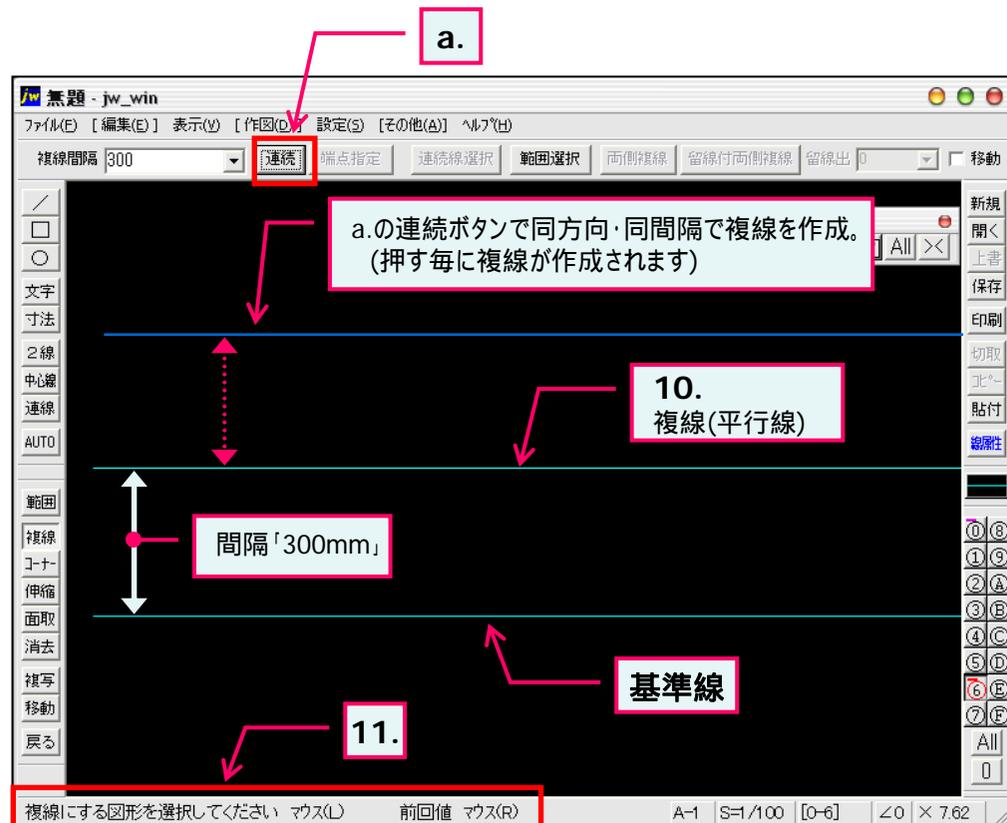
10. 基準線より上方向をマウス左ボタンクリックすることにより左図のように基準線より上部へ複線(平行線)が作成できました。
