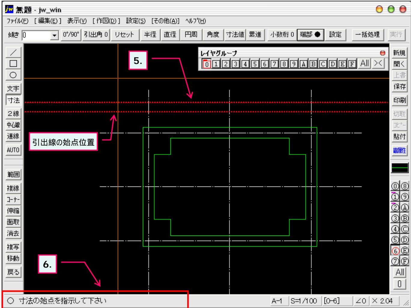
5. 寸法線の位置を指示します。(寸法線の位置が仮表示線で表示されます。)
